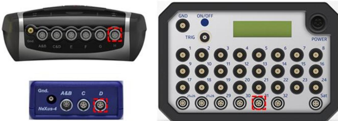
Die Sensoren können durch Ziehen des silbernen gerippten Teil des Steckverbinders nach hinten, getrennt werden.
