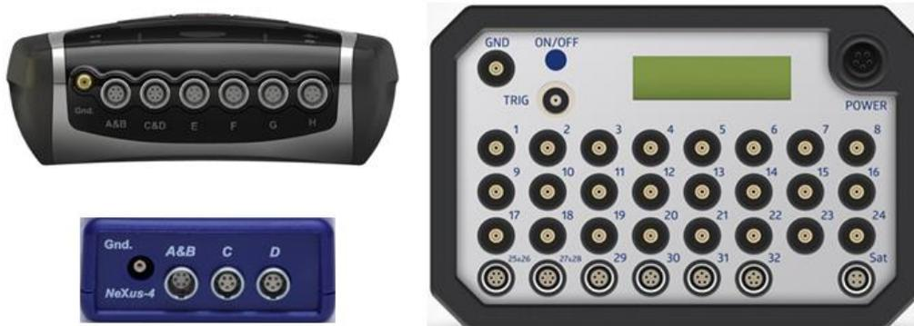
Verbinden Sie die EXG-Erdung mit der Erdung (Gnd) des NeXus.
