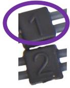
Bringen Sie den schwarzen Schnappverschluss von Paar 1 des EXG-Sensors und den Erdungsschnappverschluss zusammen mit den Scheibenelektroden an einem Ohrclip an.
