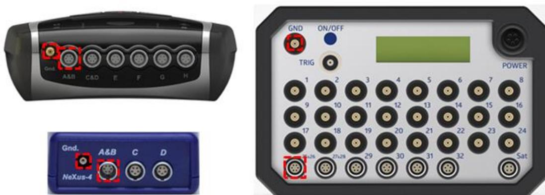
Die Sensoren können durch Ziehen des silbernen grippten Teil des Steckverbinders nach hinten, getrennt werden.
