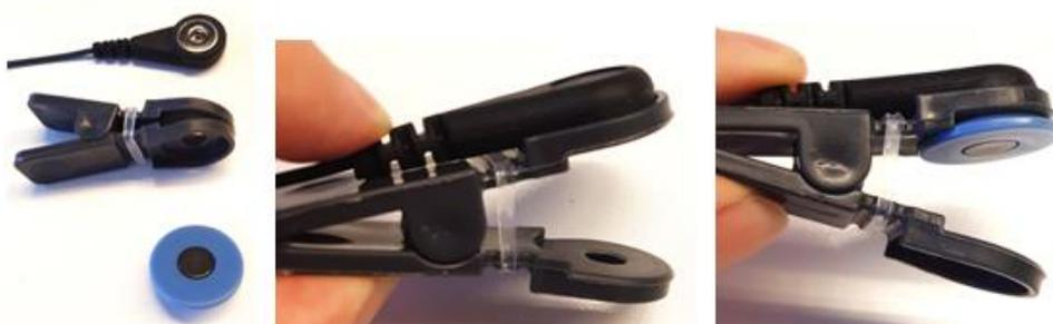
Zum Anbringen von EEG-Elektroden an den Ohren mit EEG/EXG-Sensoren mit den LOT-Nummern L2101 und höher (Februar 2021) werden die EEG-Scheibenhorelektroden in Kombination mit Ohrclips verwendet:
