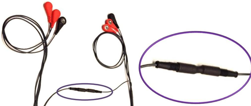
Legen Sie die Scheibenelektroden auf die vier roten Schnappverschlüsse und eine Scheibenelektrode auf den EXG-Erdungsschnappverschluß.
