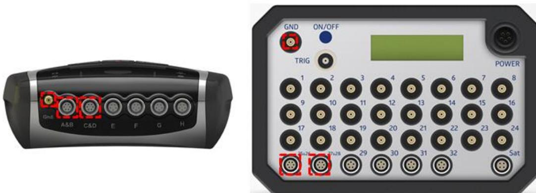
Die Sensoren können durch Ziehen des silbernen gerippten Teil des Steckverbinders nach hinten, getrennt werden.
