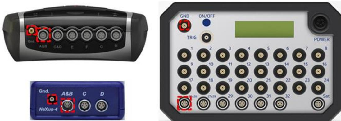
Die Sensoren können durch Ziehen des silbernen gerippten Teils des Steckverbinders nach hinten getrennt werden.
