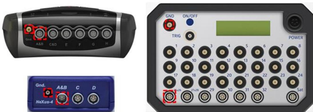
Die Sensoren können durch Ziehen des silbernen gerippten Teil des Anschlusses nach hinten, getrennt werden.
